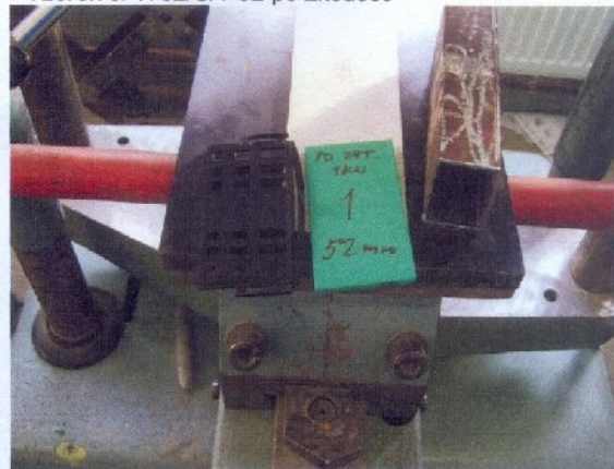
Vzorek č. 1782/S/6-52 po zkoušce – zatížení min.5kN
