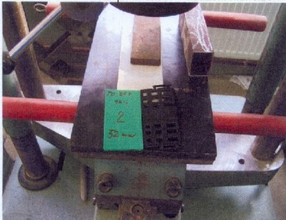
Vzorek č. 1782/S/2-52 po zkoušce – zatížení min.1kN
